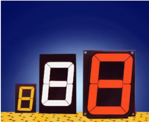
電磁式表示器、「シグナレックス」は、米国 COLORADO TIME SYSTEMS社製で、7個の電磁式セグメントで構成されて、数字を表示します。昼間の野外でも、はっきりと良く見える特殊テープをセグメントに使用していますので、公共施設での使用に最適です。寿命も2億回のサイクル試験に合格し、米国では絶大なる信頼性を維持しております。文字寸法は最大305×204mm、最小40×24mmです。全部で5種類の寸法を取り揃えています。
