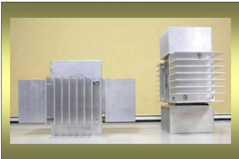
熱発電素子ユニット YGU-002P は 市販カセットガス、ジュニアバーナーと組み込めると発電する装置になる。LED 照明、ラジオ、テレビの電源供給、携帯電話の充電が可能です。
