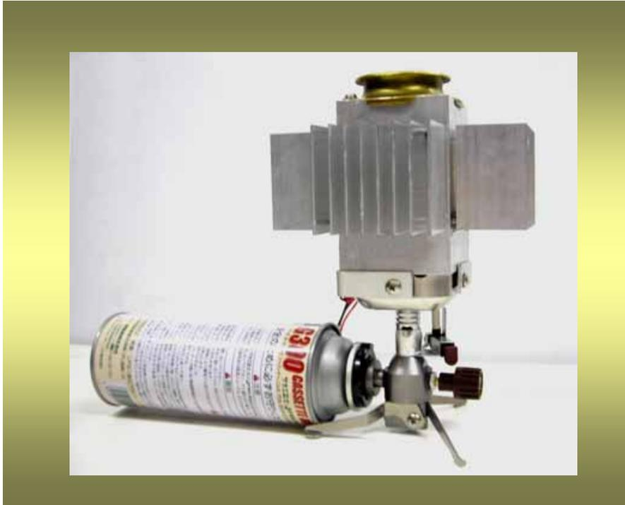
市販カセットガス、ジュニアバーナーと熱発電素子ユニット YGU-002 を組み込んだ発電する装置。LED 照明、ラジオ、テレビの電源供給、携帯電話の充電が可能です。
