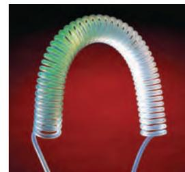
ZEUSは、独自の製造プロセスにより、ふっ素樹脂チューブを「ヒートセット」してらせん状コイルに加工し、優れた柔軟性と伸縮性を実現しています。ヒートセットでらせん状に加工したチューブは、引き伸ばしたり、縮めたり、本来の形状に戻したりできます。ZEUSでは、お客様のご希望の寸法、コイル、色のチューブをカスタムメイドしています。
